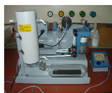
Instalatie distilare/filtrare vid
